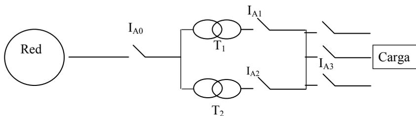
Determinar el poder de corte del interruptor automático de la carga representada en la figura, suponiendo para el cálculo que las tensiones en cada punto son las nominales.
